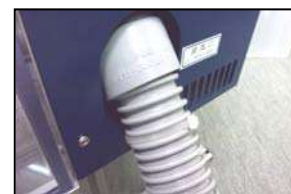
ホースが抜けないように インシュロックで固定します。
