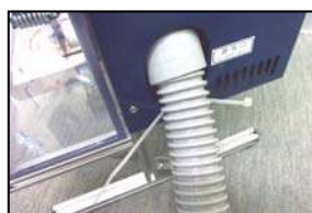
ホースにジョイントを付けて、 排気口に接続します。
