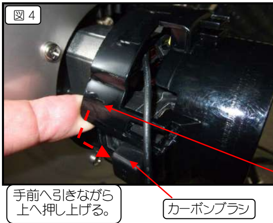
③ プラスチックカバー下部を指で外方向に引きながら押し上げるとカバーが外れます。(反対の部分も同じように外します)
