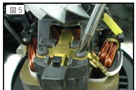
④ カーボンブラシを押えている金具を、+ドライバーを使用して緩めてカーボンブラシを外し交換して下さい。
