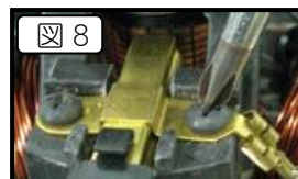
④ カーボンブラシを押えている金具を、+ドライバーを使用して緩めてカーボンブラシを外し交換して下さい。
