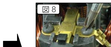
④ カーボンブラシを押えている金具を、+ドライバーを使用して緩めてカーボンブラシを外し交換して下さい。
