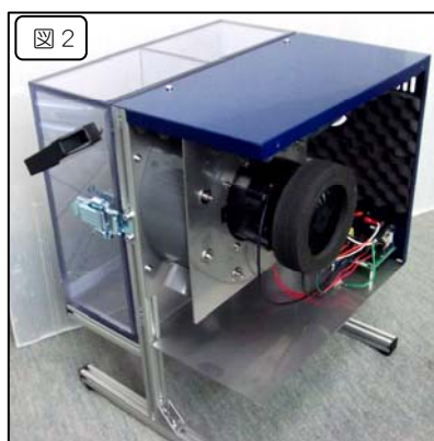
① (図1)の5箇所のネジを外すと、L型のふた部分が取り外せて、モーター本体が見えてきます。(図2)
