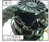
③ モーター本体に取り付けてあるプラス チックカバーに沿わせてある配線コード を外してから図4を参考にプラスチック カバーを外します。
