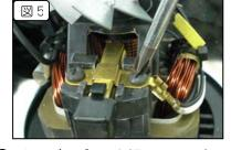
⑤ カーボンブラシを押えている金具を、 プラスト・ライバーを使用して緩めて カーボンブラシを外し交換して下さい。
