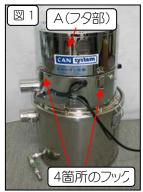
① (図1)の4箇所のフックを外すと、 Aのふたの部分が取り外せて、 モーター本体が見えてきます。
